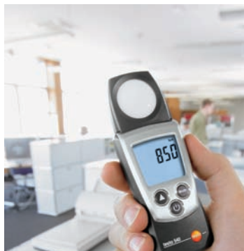
Измерение интенсивности освещенности на рабочих местах
