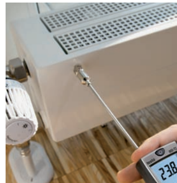
Измерения поверхностной температуры радиатора
