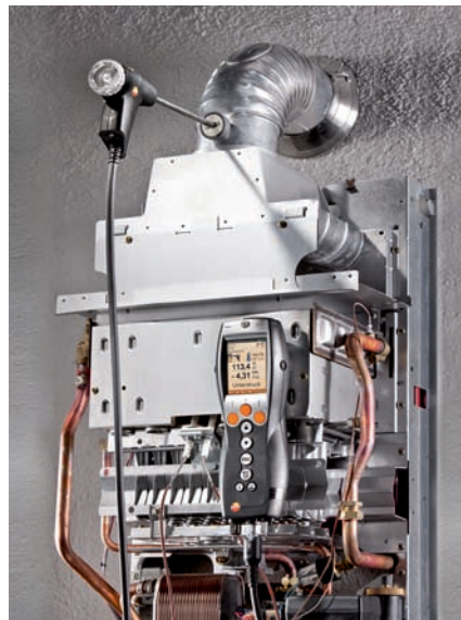
Рис. 8: Для осуществления настройки необходимо иметь анализатор дымовых газов, например, testo 330
