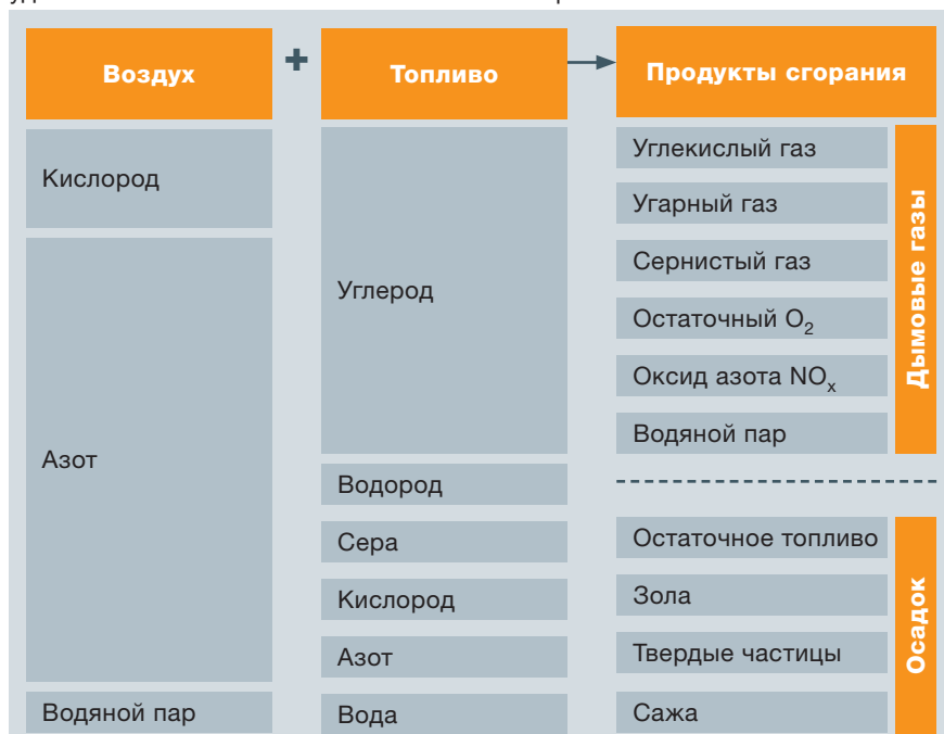
Рис. 1: Состав топлива / дымовых газов
