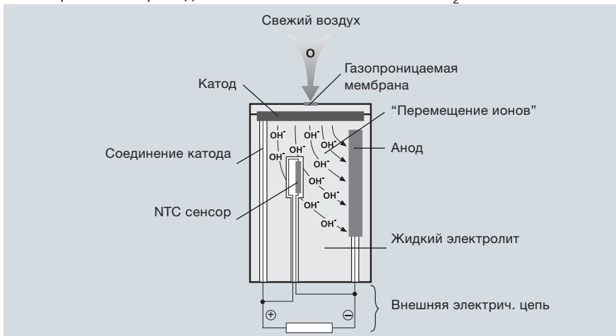
Рис. 21: Принцип работы кислородного сенсора
