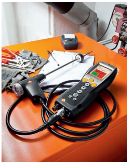
Рис. 19: С помощью анализатора дымовых газов Вы можете быстро и точно рассчитать значения всех ключевых параметров.
