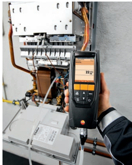
Рис. 15: Прибор testo 320 может использоваться как для анализа дымовых газов, так и для быстрого и точного измерения абсолютного и дифференциального давления.
